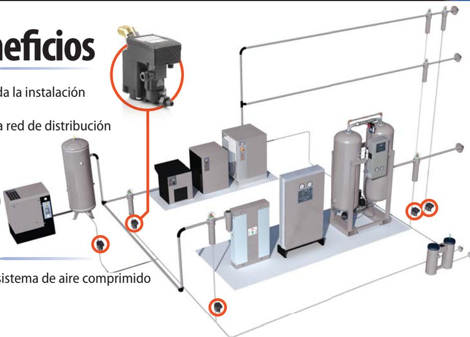
La nueva gama LD funciona utilizando un sistema llamado descarga de condensado capacitivo. Comparado con los sistemas de purgas tradicionales por temporizador, este nuevo sistema presenta varias ventajas:
